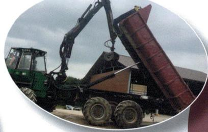
Une grue équipée d'un Tilt pour la mettre de niveau dans les côtes d'une portée de 10 m. D'une force de 10 T.m.
